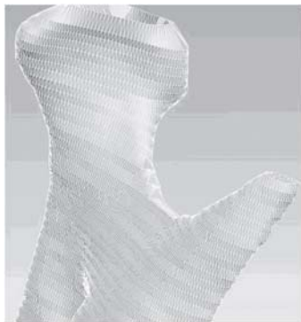
Figura 4. Triangulación Wrap de la nube de puntos
